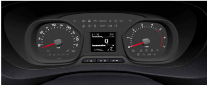
Instrumentenpaneel 1, met brandstofniveau en koelvloeistoftemperatuurandauiding in centraal vakje. Standaard op Comfort, met uitzondering van versies met ETG6 of EAT6, of bij touchscreen.
