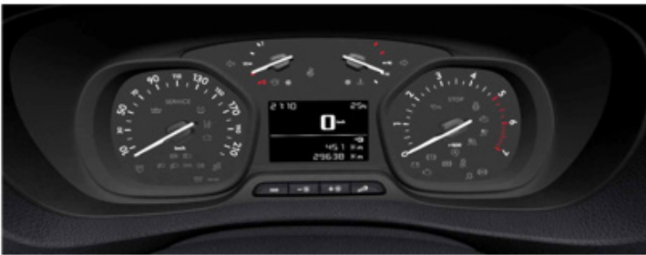
Instrumentenpaneel 2, met aparte meters voor brandstofniveau en koelvloeistoftemperatuur. Standaard op Comfort met ETG6 of EAT6, of met touchscreen. Standaard op Club, behalve bij opties Pack Safety 1 (Li01) of Navigatie.
