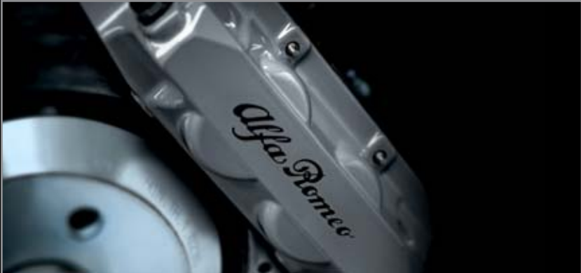
Dual-cast geperforeerde en inwendig geventileerde remschijve, 305x28 mm, met vaste Brembo-vierzuigerremklauwen.
