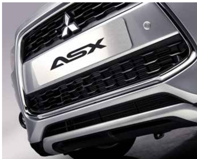
Vooruitrijdetectie/parkeerhulp 4 sensoren in carrosseriekleur gespoten
