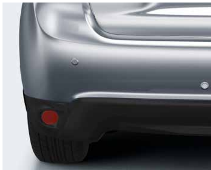
Achteruitrijdetectie/parkeerhulp 4 sensoren in carrosseriekleur gespoten
